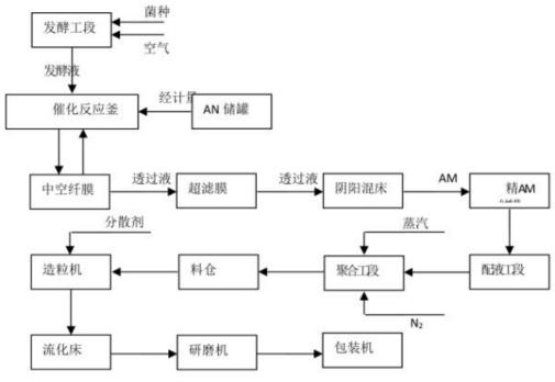
图 2.2-1 宝莫聚丙烯酰胺生产工艺流程简图
